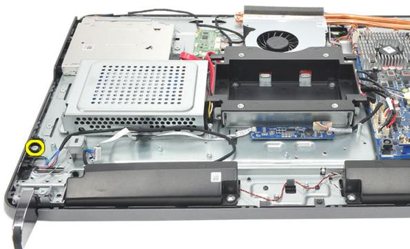
6. Desconecte o conjunto da chave liga/desliga da placa de sistema.
