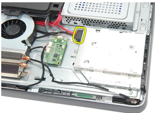
4. Remova o parafuso que prende a unidade óptica ao chassi.
