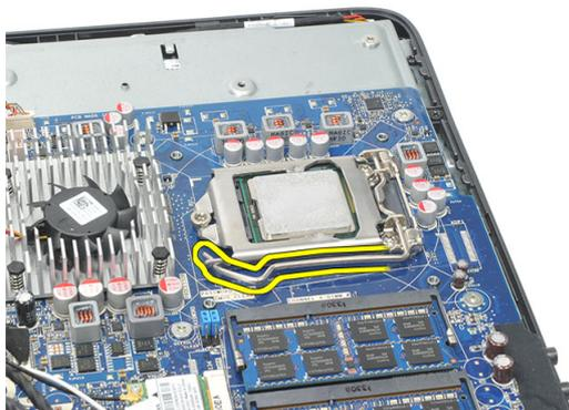
10. Levante a tampa do processador e remova o processador do soquete. Coloque em uma embalagem antiestática.
