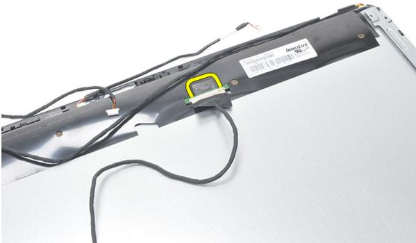
**16.** Desconecte o cabo de LVDS de seu respectivo conector e remova-o do computador.
