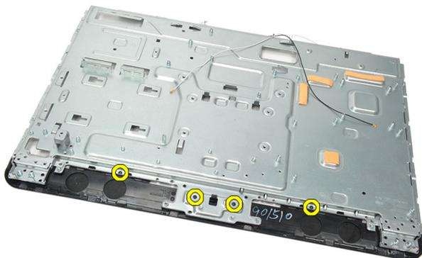
11. Retire a tampa do alto-falante solta do chassi e remova-a.
