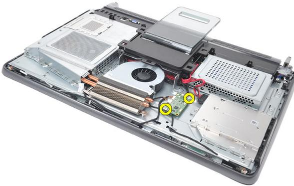
5. Levante a placa de controle da tela sensível ao toque do chassi.
