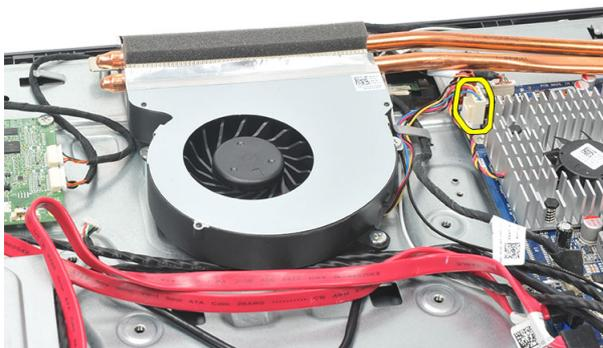
8. Remova os parafusos que prendem o ventilador da CPU ao chassi.
