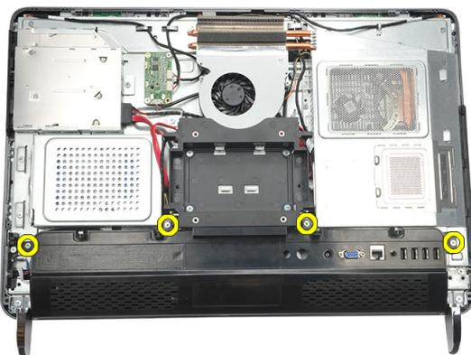
5. Retire a tampa de E/S traseira solta do chassi e levante-a.
