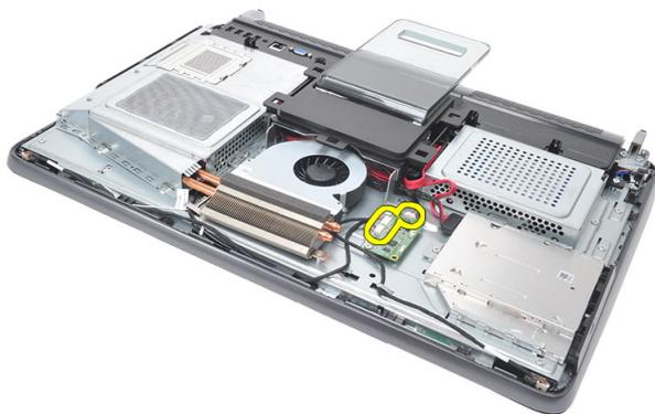
4. Remova os parafusos que prendem a placa de controle da tela sensível ao toque.
