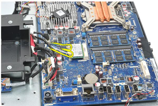
7. Remova o parafuso que prende a placa WLAN e remova-a do computador.
